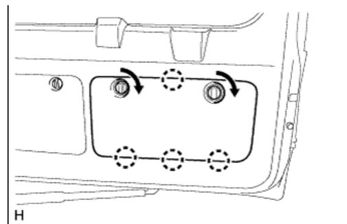
**5. REMOVE UPPER TOOL BOX PANEL SUB-ASSEMBLY**
