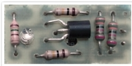
Montaż tranzystora T1
