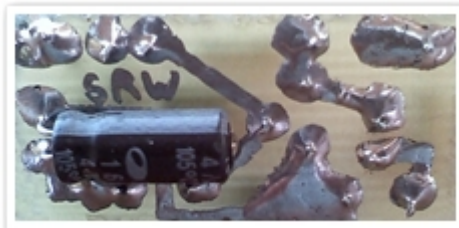
Montaż kondensatora C1
