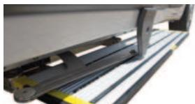
Total Ausfahren von Trittstufe durch minimalen Hub der Fahrzeugtür.
