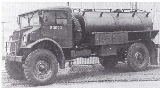
Een Chevrolet C 60L, 3 ton, 4x4 brandstoftankwagen, zoals gebruikt door het Korps Motortransport Nederland. (Bron: Tilburg als militaire stad van Herman Roozenbeek).
